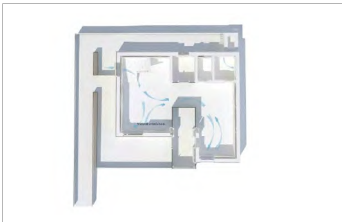
Ventilarea naturală prin cross-ventilation
