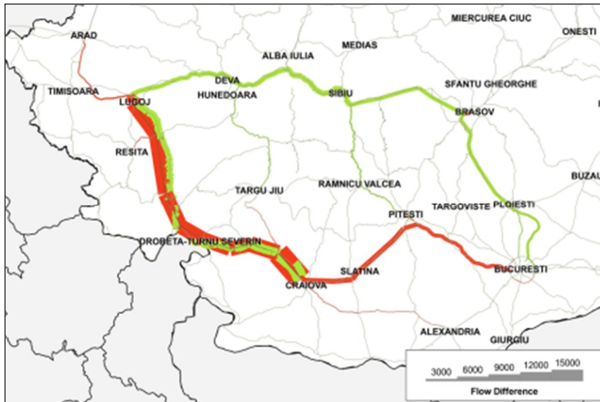
Figura 4.45 Modificări ale fluxului de trafic datorate proiectului pentru drumul expres Lugoj – Craiova
