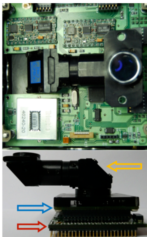
Fig. 2 - CICLOP: senzor (roșu), procesor de imagine (albastru), obiectiv (galben)
