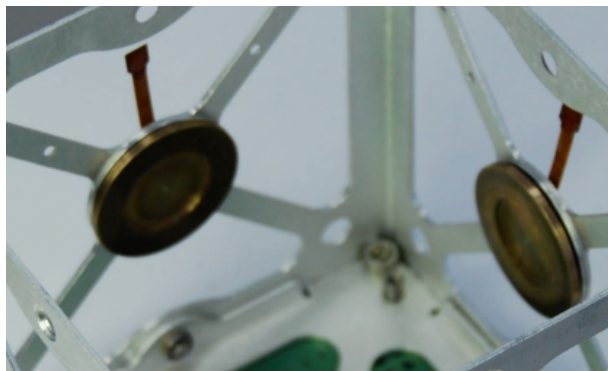
Fig. 8 - Volanți și micro-motoare montate pe structura satelitului
